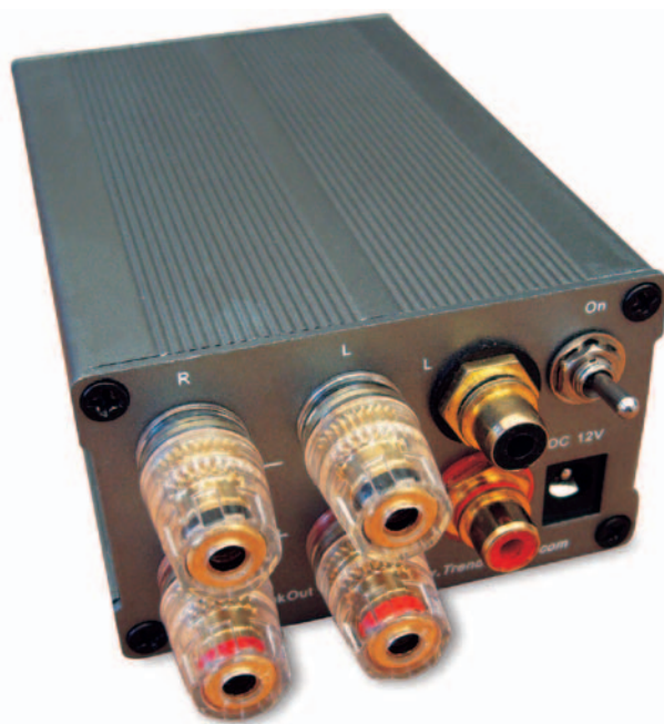
Trends Audio TA-10.1 er så lille at selv helt almindelige højttalerudgange fylder det meste af bagpladen.
